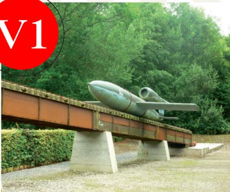
> Petit avion sans pilote : certains pouvaient être lancés à partir d'un avion. Mesurant 8m5 de long, il pèse 2,5 t emportant une charge explosive d'environ 850 kg.
