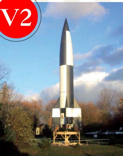
> Fusée d'une conception totalement révolutionnaire pour l'époque. Le V2 pèse 12 t mesure 14 m de haut pour 1m65 de diamètre. Il décolle de façon verticale, comme une fusée. Le V2 transporte environ 750 kg de charge explosive et a une portée d'environ 350 Km.
